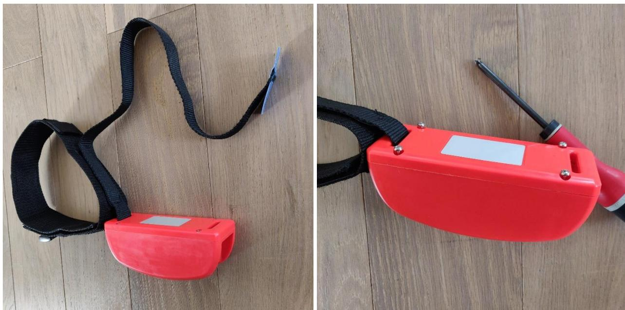
Avant l'ouverture du boîtier nettoyez avec un chiffon humide ou une éponge l'extérieur de votre CAL, ou brossez-le. Dévissez les quatre vis imperdables du couvercle du boîtier. Soulevez doucement le couvercle de la batterie. Débranchez la batterie de l'appareil en appuyant doucement sur le petit bouton de verrouillage, déverrouillage du connecteur. Pour débrancher la pile de son connecteur ne tirez surtout pas sur les fils, le connecteur doit se débrancher doucement d'une simple pression.
